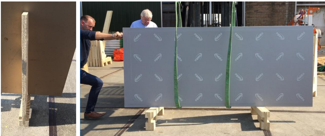
Figuur 8: Prototype volgens maatvoering basisbok. Bok uit één geheel. Plaatmateriaal Kerto 40mm dik. Verbrede basis van 12cm: goede zijwaartse stabiliteit. Aanbeveling: plaatsteun mag minder hoog, circa 90cm is voldoende.
