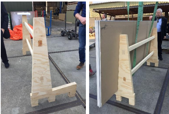
Figuur 9: Prototype van basisbok. Bok uit plaatmateriaal. Multiplex 2x25mm dik. Dwarsbalk zorgt voor goede zijwaartse stabiliteit. Aanbeveling: plaatsteun mag minder hoog, circa 90cm is voldoende.
