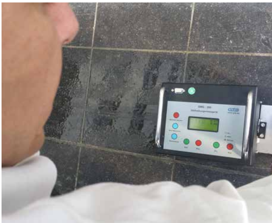
Meting op droge en (hier zichtbaar) ruim benat oppervlak.
