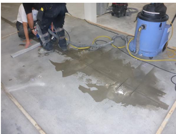
Figuur 15 Uit de dekvloeren worden monsters gezaagd ten behoeve van laboratoriumbeproeving op druk- en buigtreksterkte.
