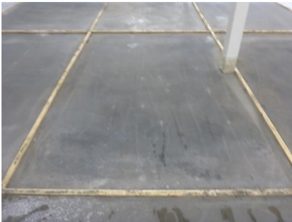
Figuur 26 Aanzicht van de proefvloeren na verwijderen folie. Proefvloeren hebben wel enige variatie in uiterlijk, afhankelijk van de toegepaste hulpstof.
