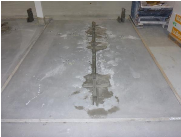
Figuur 18 Ruim langs de zaaglijn worden trekkoppen voor huidtreksterktemetingen op de proefvloeren gelijmd en vervolgens afgetrokken.
