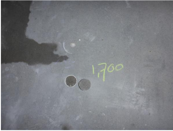
Figuur 19 Op enige afstand van de huidtreksterktebeproevingen zijn ook gebruikswaardebepalingen uitgevoerd.
