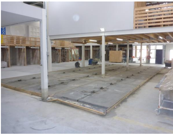
Figuur 17 Resultaat na enig zaagwerk: monsters kunnen worden gecodeerd en naar het laboratorium.
