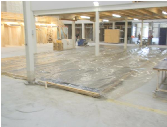
Figuur 12 Proefvloeren worden aansluitend direct onder folie geplaatst tot aan het moment van beproeving.
